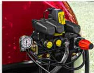
Comando elétrico de duas vias, vazão de 150 l/min e 40 BAR de pressão.
